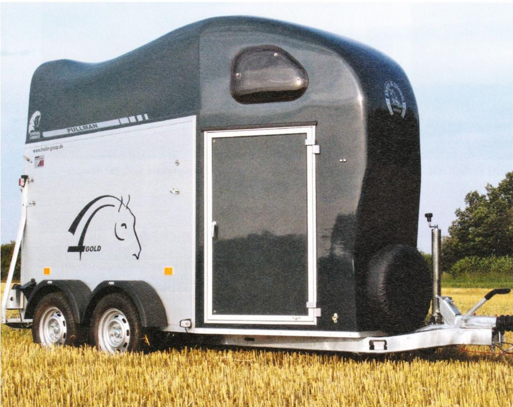
**M**it neu überarbeitetem Pullman Fahrwerk (V2), das ein hervorragendes Fahrverhalten bietet, und größerer Sattelkammer, die in einem Polyesterbug Platz gefunden hat, besteht der Rest des Hängers wie sein Vorgänger aus robustem Aluminiumaufbau. Zur Verfügung gestellt wurde der Test-Pferdeanhänger von den Anhängercentren Ahrens & Ullmann in Stuhr bei Bremen.
