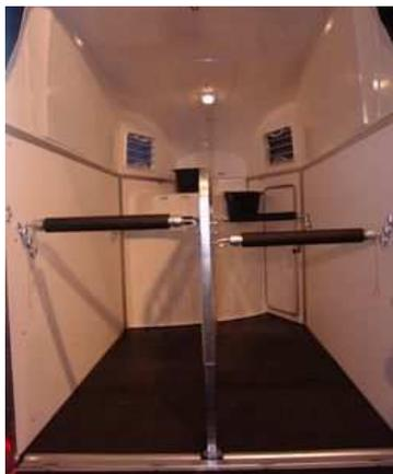
Auch in der Innenlänge ( 3,15 m bzw. 3,44 m in der AERO-Version ) und -breite (1,71 m) haben die Fahrzeuge um zwei Zentimeter zugelegt. Zu dem aktualisierten Raumkonzept gehören auch die serienmäßigen längen- und höhenverstellbaren komfortabel gepolsterten Brust- und Heckstangen, die in schräg nach unten verlaufende Schiene eingehängt werden.
