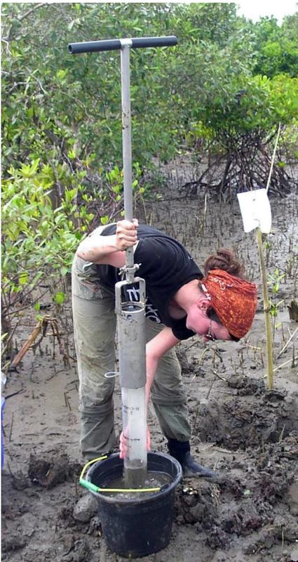
Entnahme eines Sedimentkerns in den Mangroven zur Analyse von Bodenverunreinigungen der Segara Anakan Lagune, Java, Indonesien. (c) Jennerjahn@ZMT
