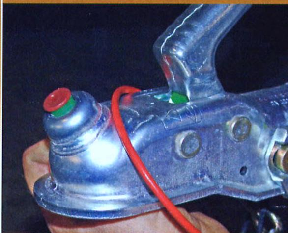
Einrastkontrolle einer Al-Ko-Kupplung.
