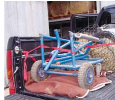
Auf jeder Ladefläche (hier beim Toyota Hilux) befinden sich Ösen für die Befestigung von (Spann)Gurten. Hat man keine professionellen Gurte, kann auch eine Longe genutzt werden.
